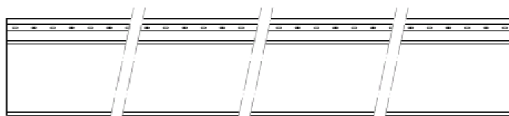
Bevestiging Keralit panelen in het midden van de sleufgaten met RVS-bolcilinderspanplaatschroeven Ø 4 mm,
